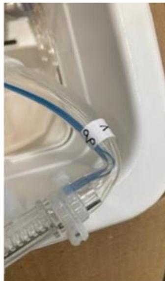
Figure 2 : Exemple de tubulure pliée
